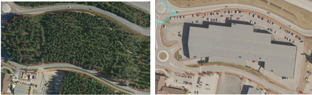
Illustrasjon 6: Bildene ovenfor viser utbygging på Hvervenmoen med en veldig økning av tette flater. Overvannsproblematikken her ble løst ved infiltrasjon til grunnen som har veldig høy infiltrasjonsevne.
