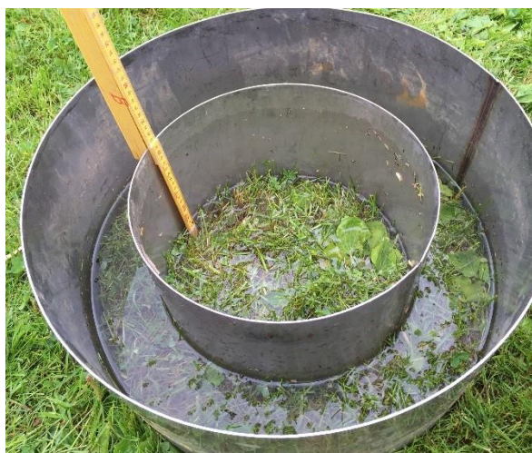
Illustrasjon 39: Bilder viser måling av infiltrasjonskapasitet (K) på en grasdekt overflate (overflateinfiltrasjon) med bruk av dobbeltring infiltrrometer (venstre) og MPD-rør (høyre). (Foto: Bent Braskerud).
