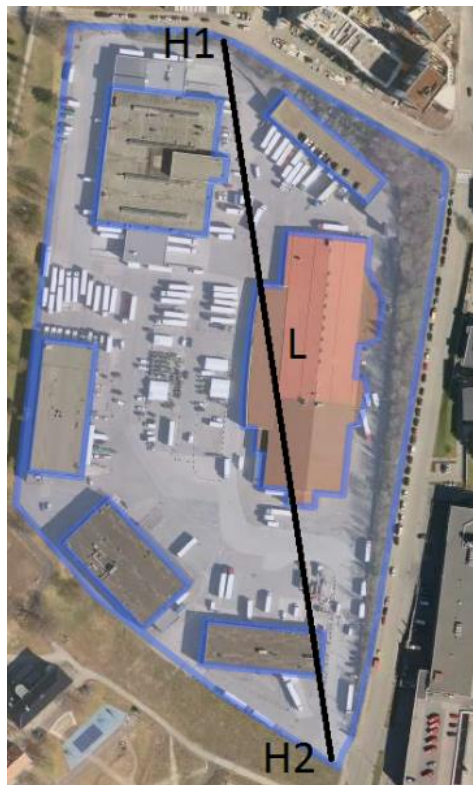
Illustrasjon 23: Viser høydene H1 og H2 ( H=H1-H2 ), fra ytterste punkt i feltet til utløpet, samt feltlengden L som er lengden mellom disse høydene.
