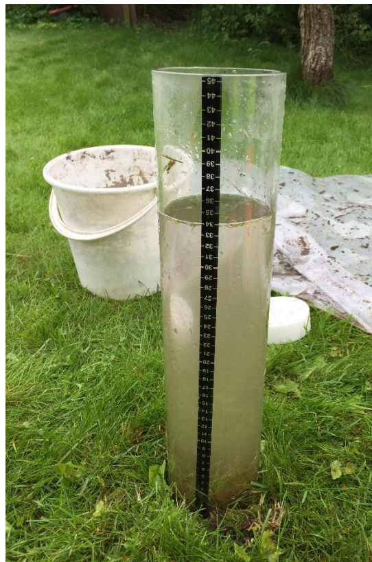
Illustrasjon 39: Bilder viser måling av infiltrasjonskapasitet (K) på en grasdekt overflate (overflateinfiltrasjon) med bruk av dobbeltring infiltrrometer (venstre) og MPD-rør (høyre). (Foto: Bent Braskerud).
