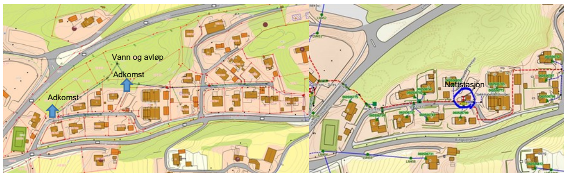
Figur 12 – Infrastruktur til planområdet i Nordberg. Tilkoblingspunkter for strøm, vann og avløp samt adkomstveier
