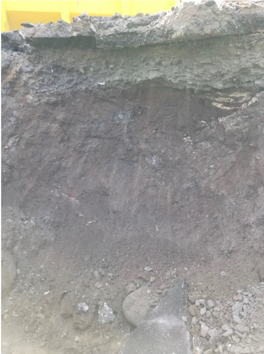
Figur 4: Prøvetakingsprofil prøve A-4. Det er tatt en jordprøve i sjakten (A-4-1).
