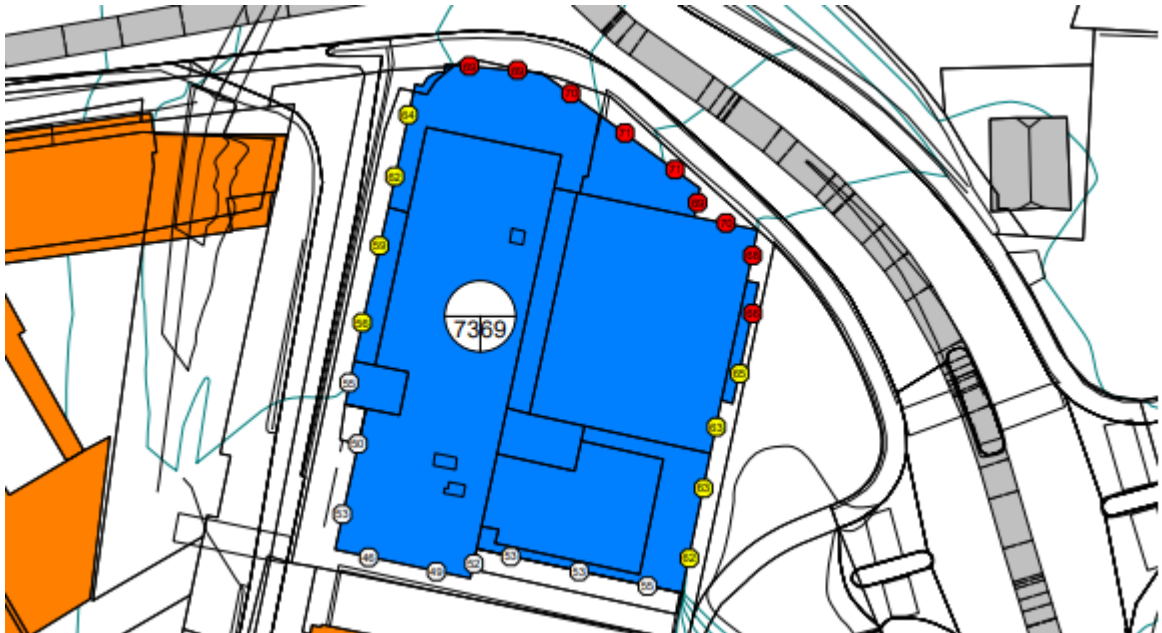
Figur 13: Støy fra vegtrafikk inkludert fasaderefleksjon for prognoseår 2032.
