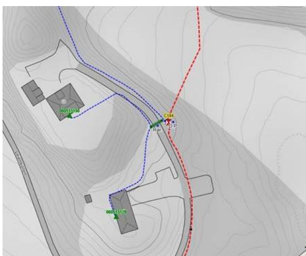
Figur 24 –Tilkoblingspunkter for strøm til Veienkollen boligfelt
