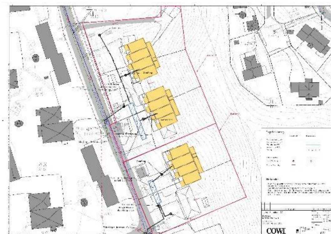
Løsning for overvann med fordrøyning.(Cowi)
