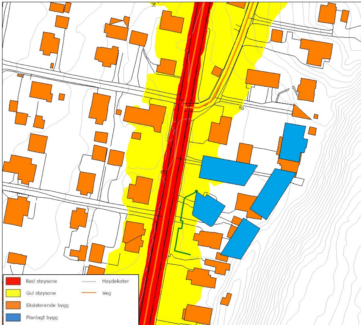
KART 7 STØYSONEKART, LDEN 4M M/SKJERMING 2,5 METER HØY
