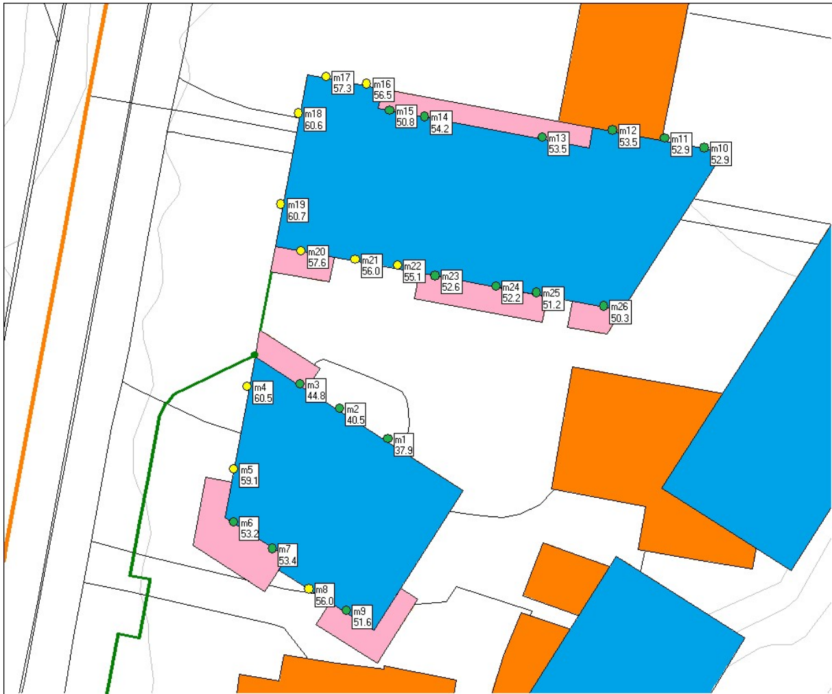
KART 11 KARTLEGGING AV STØY M/STØYSKJERM 1,2 METER HØY, BYGG B OG C 1. ETASJE, LDEN
