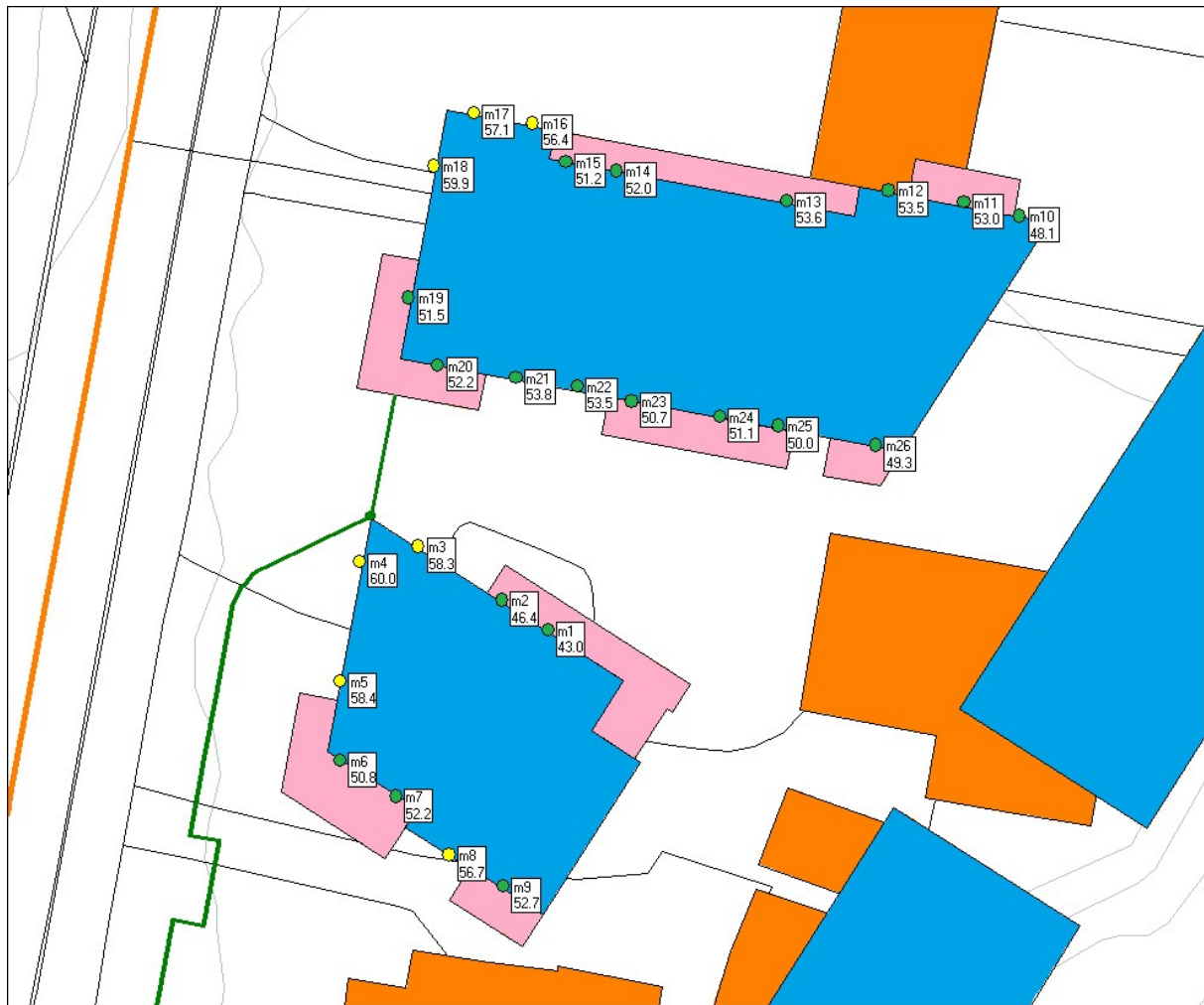
KART 14 KARTLEGGING AV STØY M/STØYSKJERM 2 METER HØY, BYGG B OG C 2. ETASJE, LDEN
