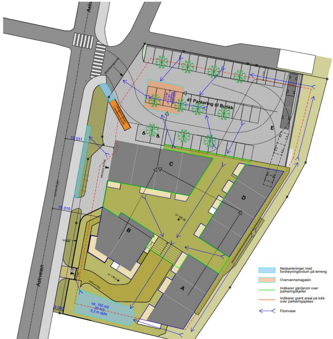
Oversikt over overvannshåndtering - flomveier
