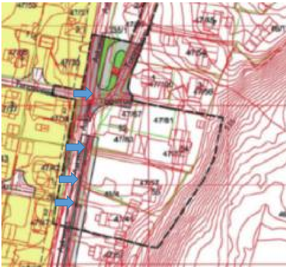
Fire avkjørsler fra Askveien i dag.
