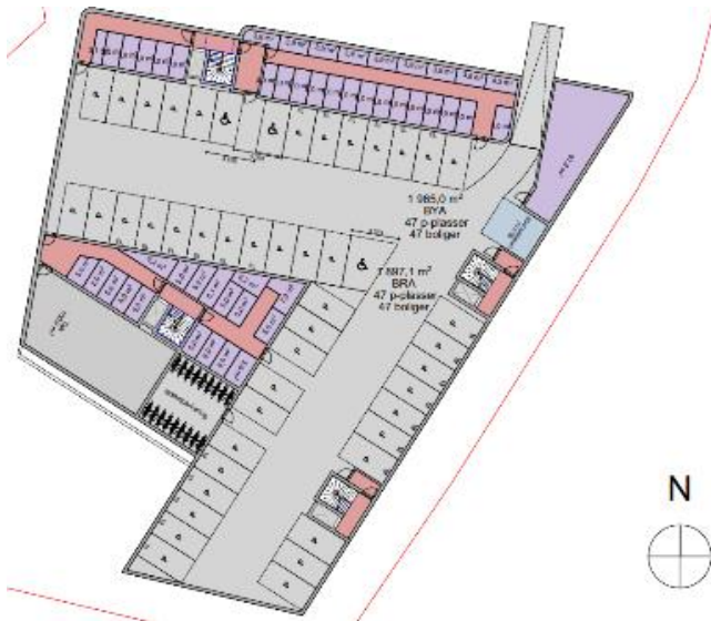
Forslag til disponering av kjelleretasje.
