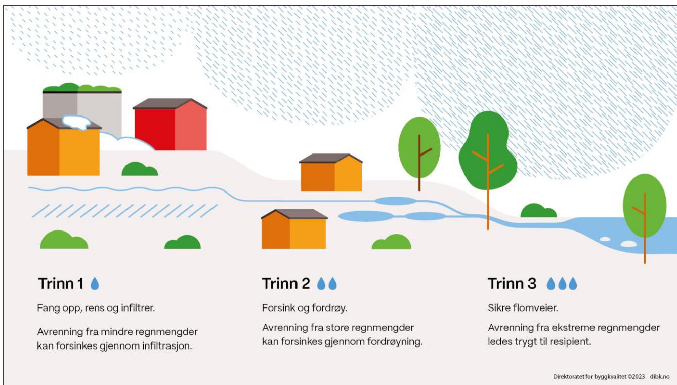
Figur 7 Tretrinnsstrategien for håndtering av overvann illustrert. Tiltaksområdet har allerede betydelig infiltrerende areal i form av tilnærmet flat grunn med myr og dyrket areal. Kilde: Direktoratet for byggkvalitet.
