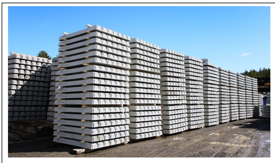
Figur 8: Nyproduserte betongsviller fra Sateba Norway AS. Svillene lagres utendørs før de blir fraktet ut av området på bane eller lastebil. Foto fra www.sateba.no .
