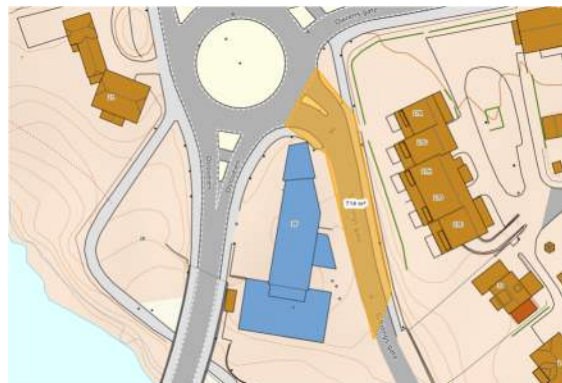
Figur 9 Avrenning fra veg til OV 315 PVC
