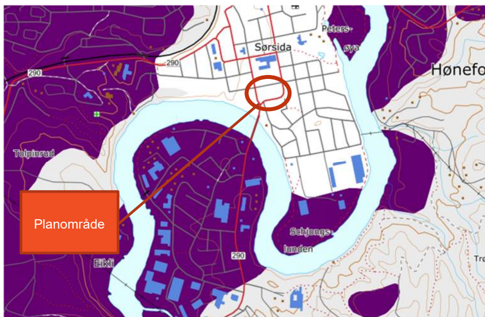
Figur 3 Kart over infiltrasjonsevne fra NGU http://geo.ngu.no/kart/minkommune/ . Infiltrasjonsevne klassifisert som ikke klassifisert (hvit). Mørk lilla er klassifisert som godt egnet.
