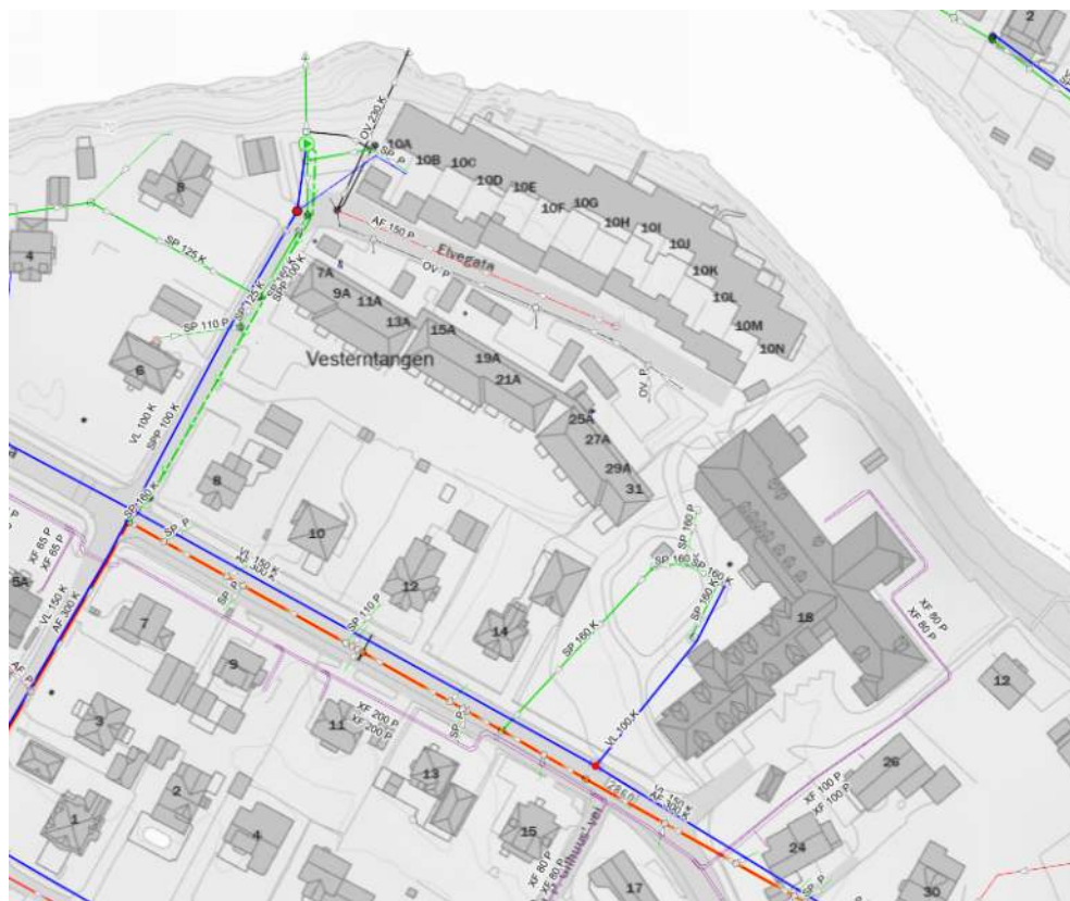
Figur 3 Planområdet og eksisterende offentlig vann- og avløpsnett. Ledningskart viser AF300 og VL150 i Vesterngata, og AF150 P og OV Pi Elvegata. Figur viser også fjernvarme (lilla) i Vesterngata og tilknytning til dagens sykehjem.
