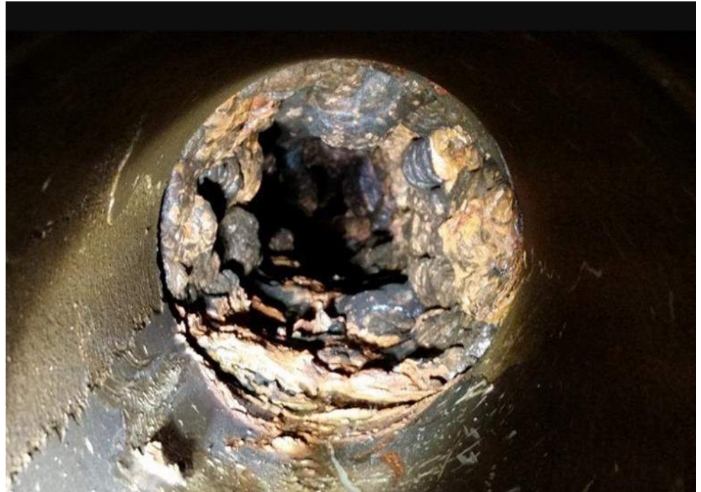
Figur 2 Vannledning i Vesterngata. Eldre rør viser redusert tverrsnitt som følge av dannelse av rustknoller
