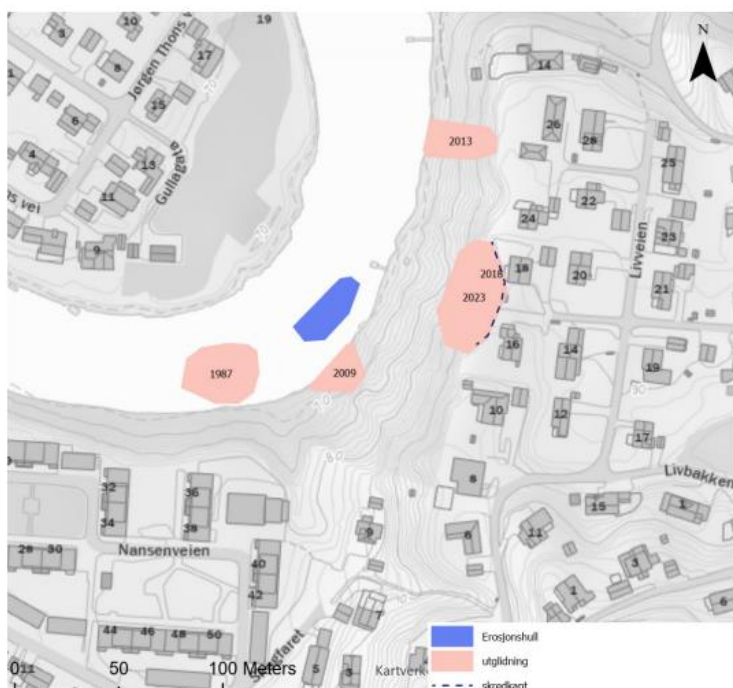
Figur 12: Utklipp fra NGI sin rapport som viser registrerte utglidninger litt lenger opp i Randselva [6].
