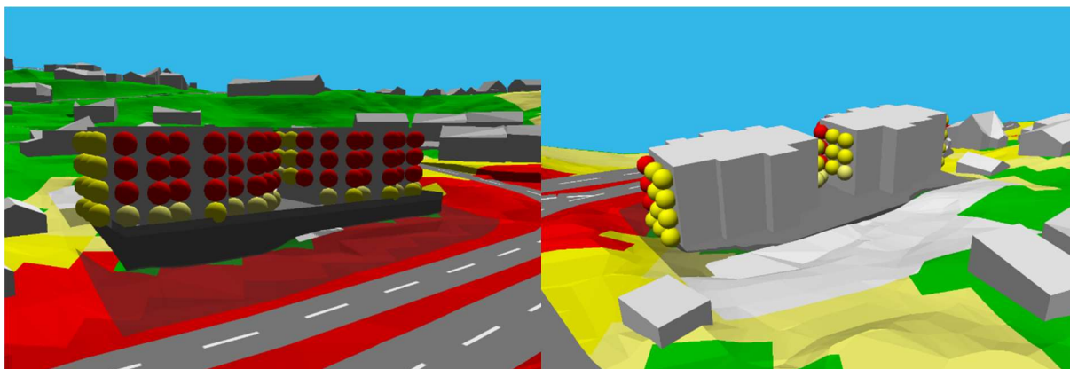
Figur 2 Mottakerpunkt fasade – foran og bak.
