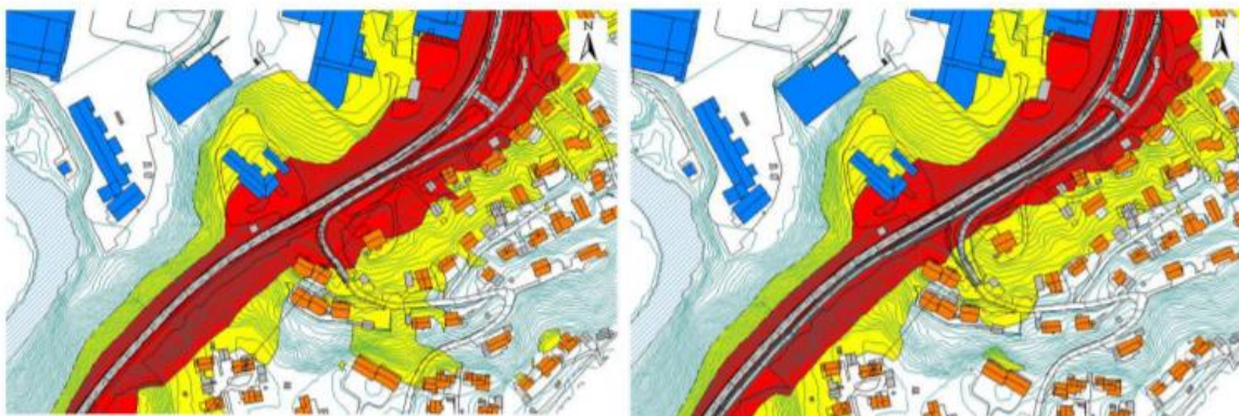
Støynivå L den beregnet i høyde 4 m.o.t. Støysonekart for situasjon uten utbygging er vist t.v. og situasjon med ferdig utbygd ny gang og sykkelveg er vist t.h.
