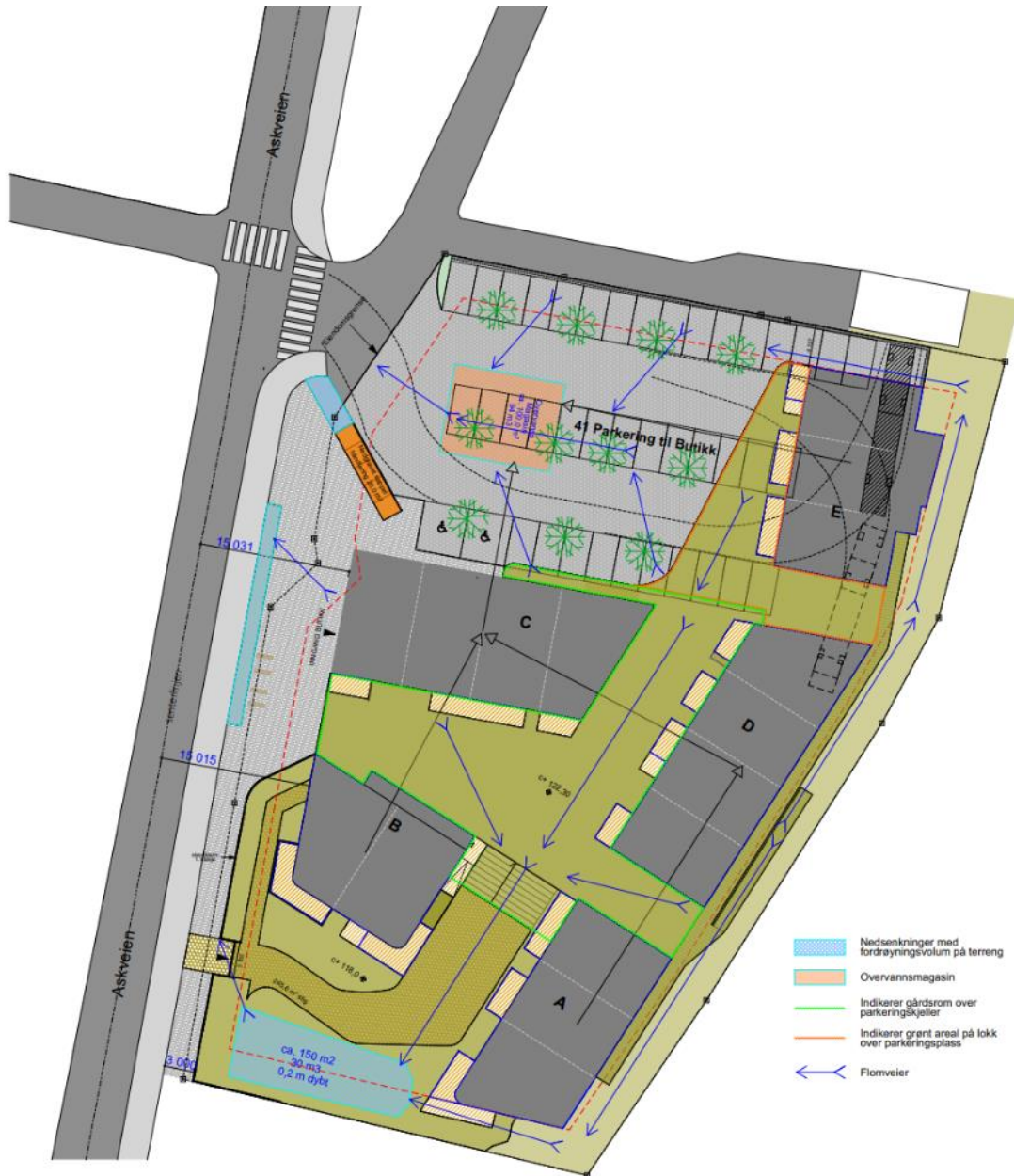
Oversikt over overvannshåndtering - flomveier
