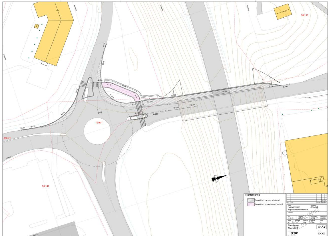
Figur 9: Alternativ 2 – anbefalt tiltak for å få tilstrekkelig kapasitet i kryssene, rundkjøring ved Hvervenmoen
