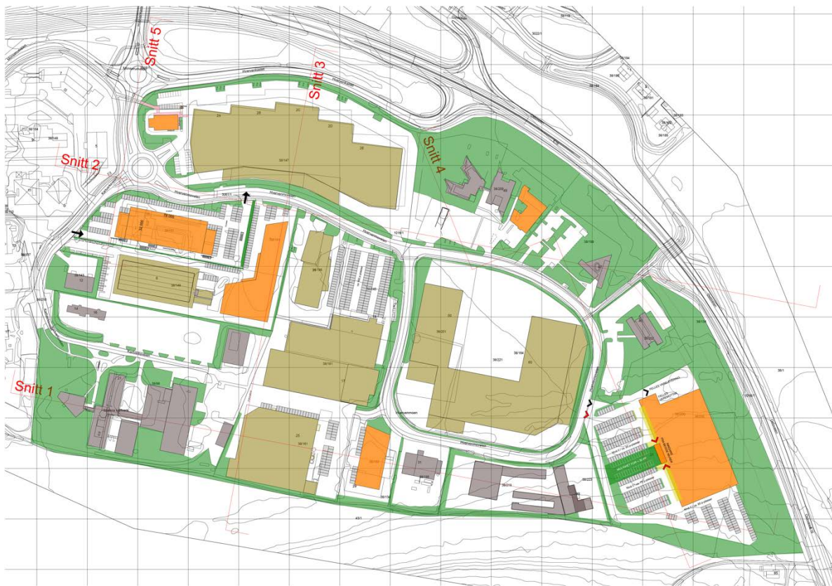
Figur 7: Enkel utbyggingskisse: grå bygg er bestående bygg der formål ikke endres, lysebrune bygg er bestående bygg der formål endres, og oransje bygg er mulige nybygg. Vestre del er ikke vist på denne planen, da det ikke er endringer her.
