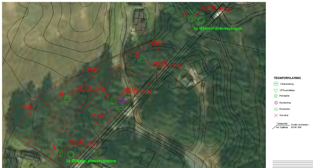
Bilde 1.6 Oversikt over utført geotekniske undersøkelser.
