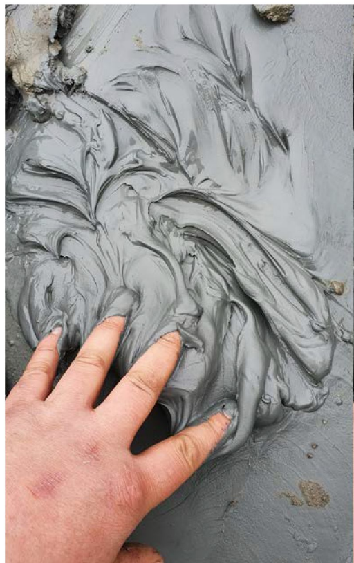
Bilde 3.7 Omrøring av den blå leiren viser at den er sensitiv.
