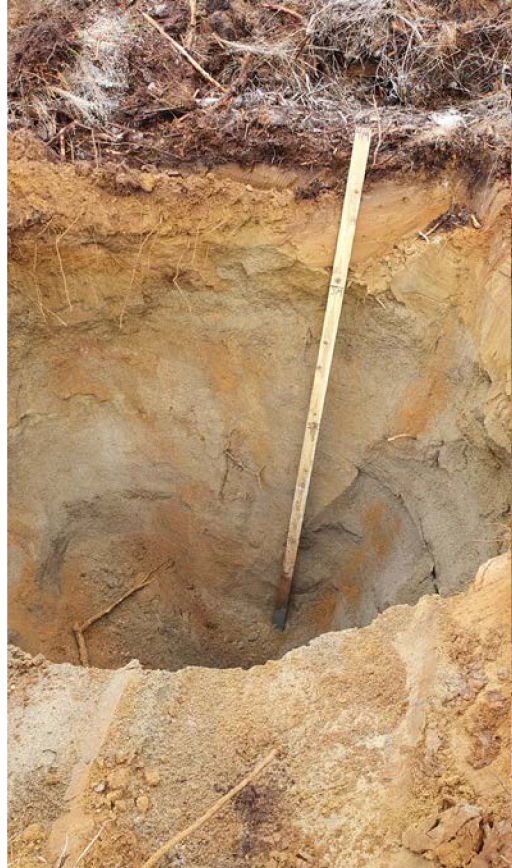
Bilde 3.5 Bilde fra PH4. Vekstjord over fin grus/ grov sand.
