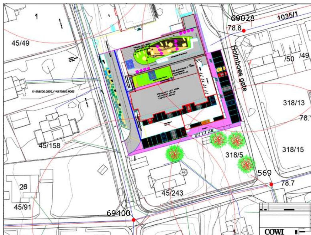
Figur 10: Skissert brannvannsdekning for Telegrafalleen 2. Dekning fra eksisterende kummer med en radius på 50 meter vist med rødt.
