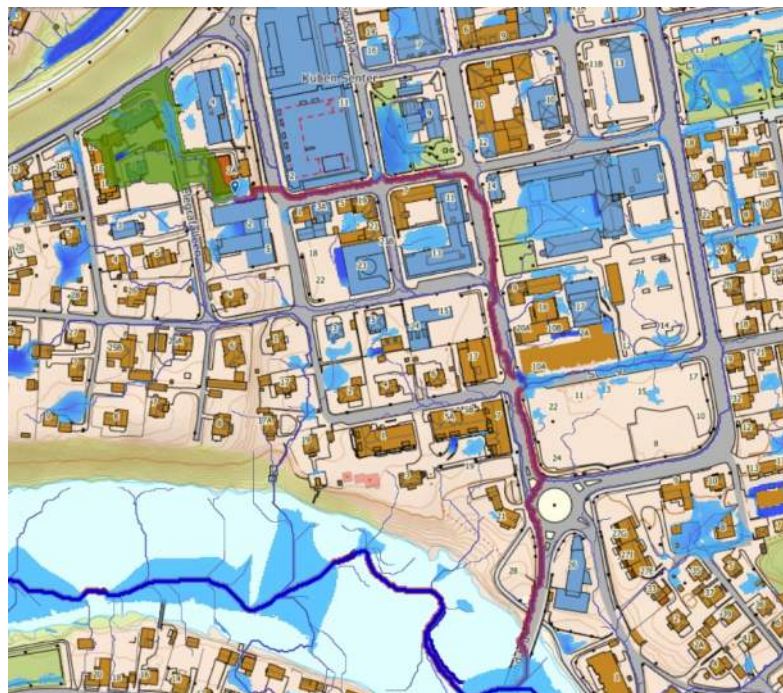
Figur 17: Flomvei for nordlig del av planområdet. Området markert med grønt har avrenning gjennom planområdet. Scalgo Live, dagens situasjon
