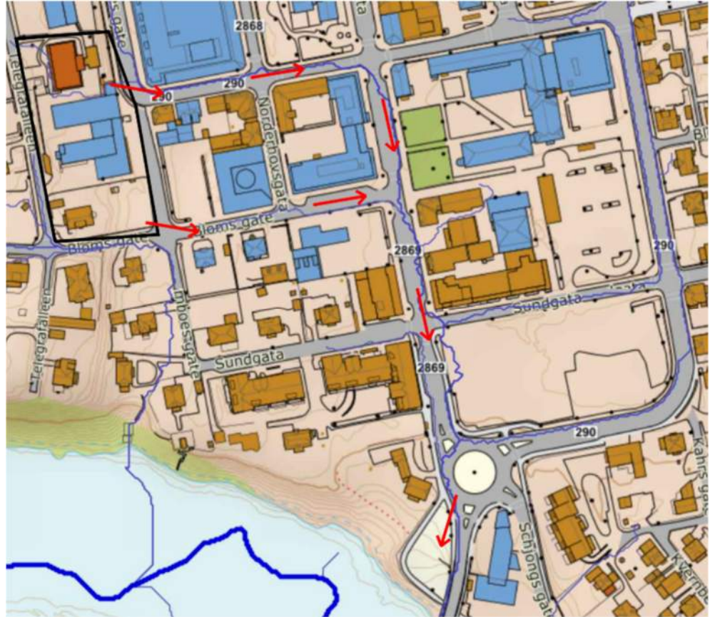
Figur 20 Avrenning fra planområdet ved ekstrem nedbør. Planområdet markert i svart, uthevet strek. Flomveier (fra planområdet til resipient) markert med rødpiler. Øvrige blå linjer er drenslinjer fra Scalgo Live.
