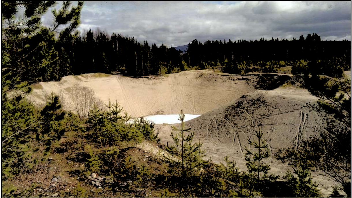
Foto fra et masseuttak på øvre flate. Bildet viser mektigheten på grusmassene. Antatt grunnvannsnivå er synlig i bunnen (isdekke).
