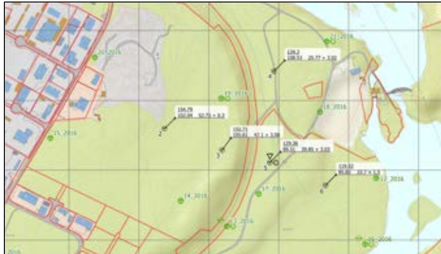
Figur 4-14 Utklipp fra borplan for nordre del av supplerende grunnundersøkelser på Follummoen 2022. De supplerende punktene er markert med svart, og de tidligere undersøkelsene er markert med grønt
