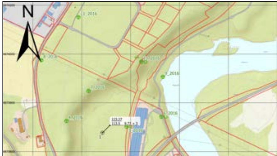
Figur 4-13 Utklipp fra borplan for søndre del av supplerende grunnundersøkelser på Follummoen 2022. De supplerende punktene er markert med svart, og de tidligere undersøkelsene er markert med grønt
