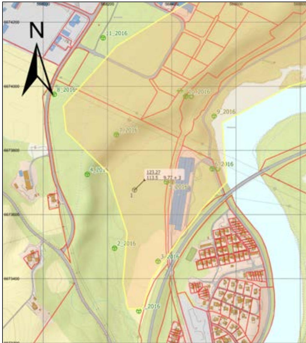
Figur 4-18 Utklipp fra borplan fra supplerende grunnundersøkelser med sammenfallende leirelag illustrert med gult og rødt.
