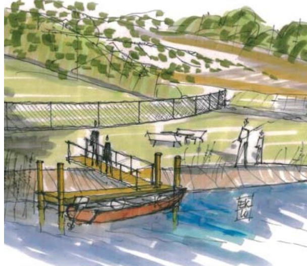
Eksempel på utforming enkel helårsbrygge eller sommerbrygge på påler (Illustrasjon: Erik Karlsen (Stiftelsen Glatved brygge))
