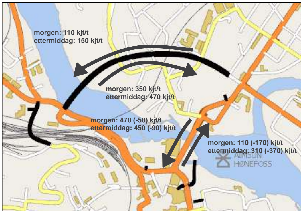
Figur 30 Trafikkmengder i rushperiodene over Hønefoss bru og ny bru. Endring sammenlignet med alternativ 0 i parentes.
