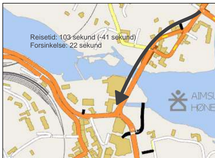
Figur 22 Reisetider for buss over Hønefoss bru i morgenrush. Endring sammenlignet med dagens situasjon i parentes.
