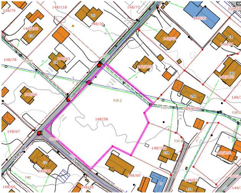
Kart 6: Viser eksisterende ledningsnett. Forslagsstiller har fått opplyst at vann- og overvannsledningen som krysser over tomten ikke eksisterer, men det er ledningene langs tomtegrensen som er reell.
