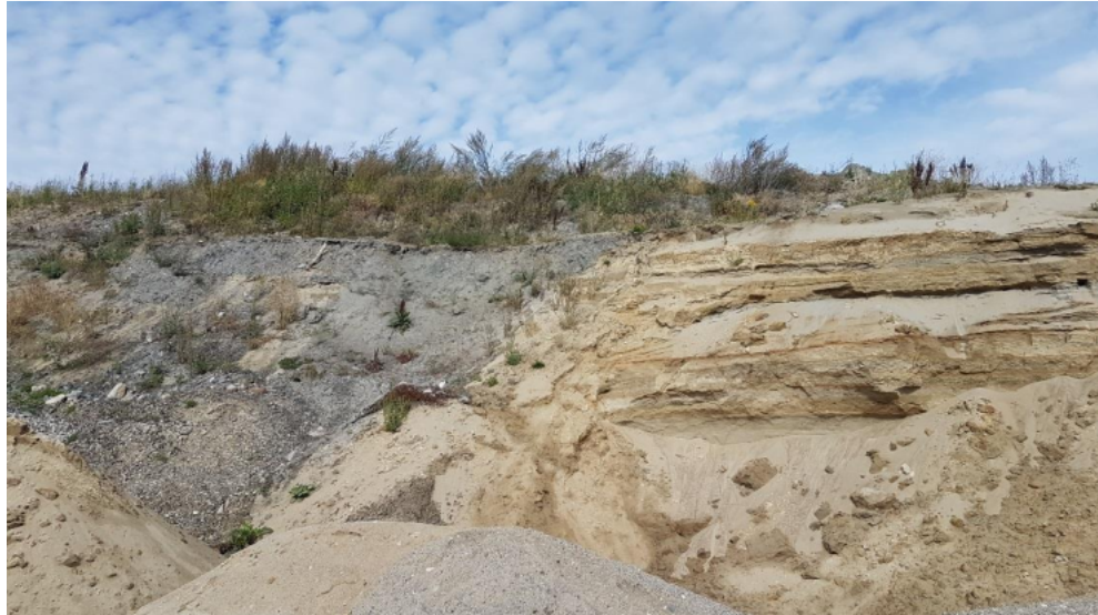
Figur 5: Fotografi fra stedet. Bildet er tatt fra ref. /1/, og viser lyse, trolig stedlige løsmasser, og mørkere tilførte masser. Materialene fremstår sandige.
